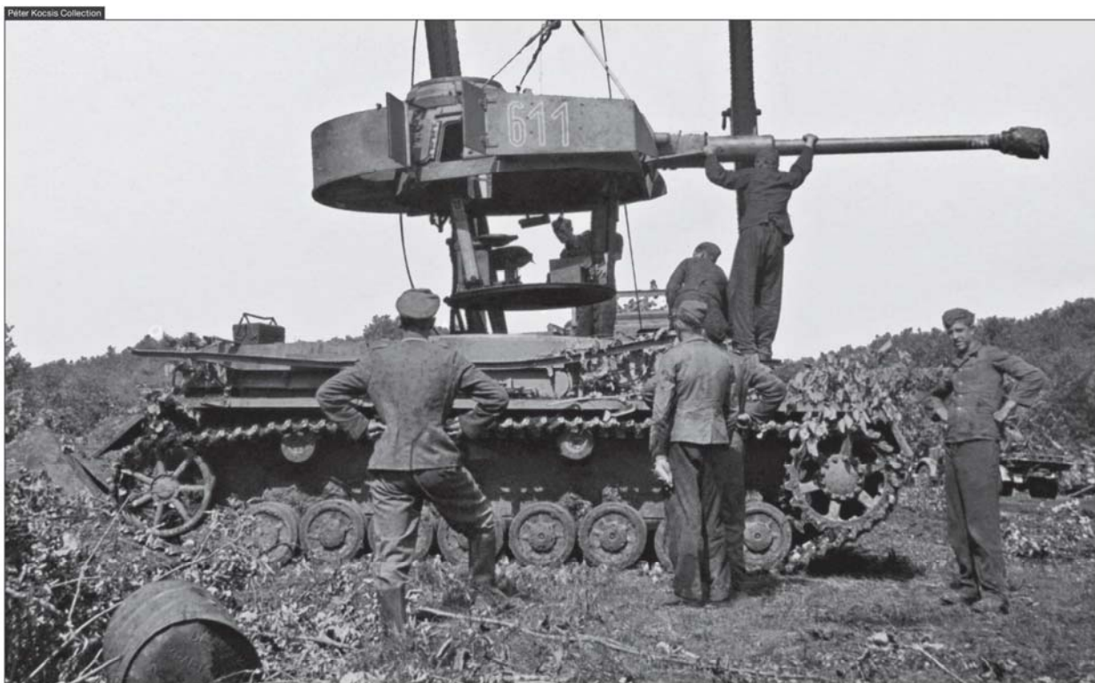
A daruvall felemelt toronynak köszönhetően jól látszik a toronykosár. A toronnyal együtt forgó küzdőtér jelentős előrelépést jelentett a háború kezdetekor használt, kevésbé jól megtervezett elődökhöz képest. A szabadon látható belsón megfigyelhető egy apró érdekesség: a kosár jobb oldali tartólábára erősített doboz, amely a tartalék géppuskacsövet rejtette magában. Ez bármilyen más szögből nézve rejtve marad. A “611”-es lövegcsövének végén pár győzelmi gyűrűt is láthatunk.
