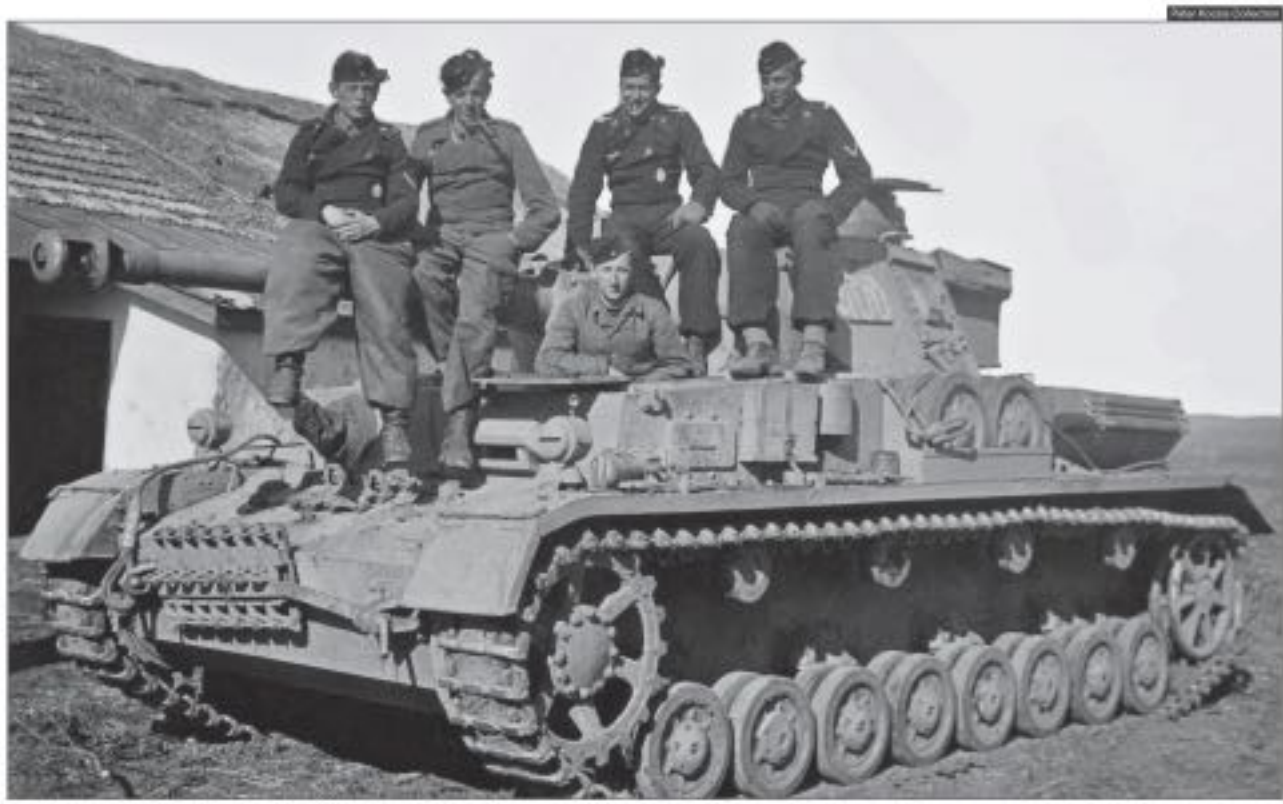
Ebből a szögből jól látható a Bosch-lámpa Vormag által kivitelezett csatlakozása – a vezeték kimeneti nyílása előrébb van a fényszóró konatánál, ezért némileg hátrafelé hajlik. Meglepő módon a torony oldalán még megtalálható a kinevezőnyílás, holott a páncélos többi jellemzője már későbbi jegyeket mutat. A 116. páncélososztályt az 1942 nyári hadművelet alatt a 16. gépkocsizó gyaloghadosztály mellé rendelték. A Kaukázusban vívott harcok során a német egységek közül ez a két alakulat jutott a háború során a legméresebb keleti irányban.
